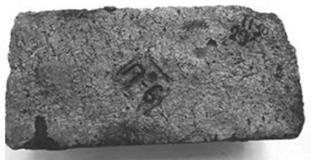
шамотна цегла невстановленого виробника від 1929 року (рік – у правому куті згори), підвал
