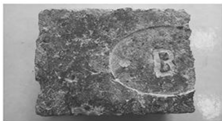
шамотна цегла невстановленого виробника, 1-й поверх правого крила
