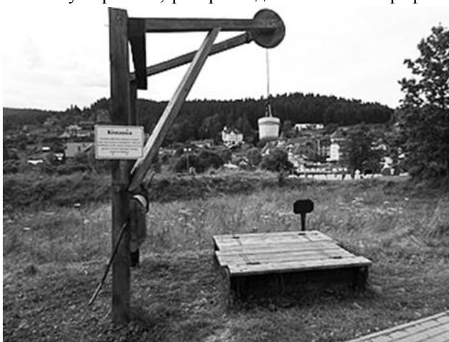
Мал. 4. Нафтовидобувний колодязь XIX ст. Реконструкція. Скансен (м. Східниця). Фото доктора технічних наук, проф. В.С. Білецького 2019 р.
