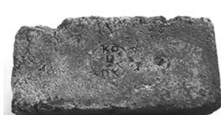
напівкисла шамотна цегла Криворізького заводу вогнетривів, підвал 6-го корпусу
